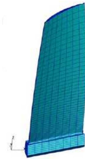
Figura 9 – Modelo em elementos finitos de uma pá (WITEK, 2009).
